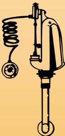
5 980 030 Batteria ad aria Pneoghisa con canotto di discesa con rubinetto a galleggiante.
